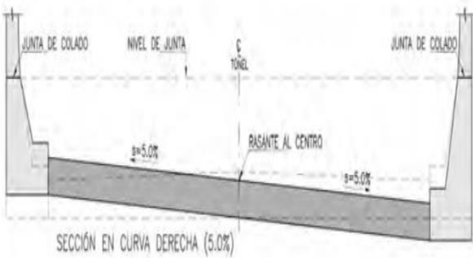
Figura 2.4. Evolución de la calzada en curva con pendiente
