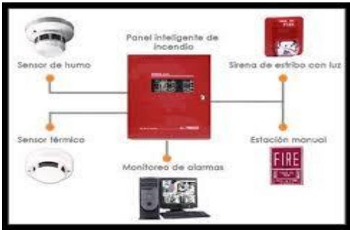
Figura 3.5. Sistema de detección de incendio.
