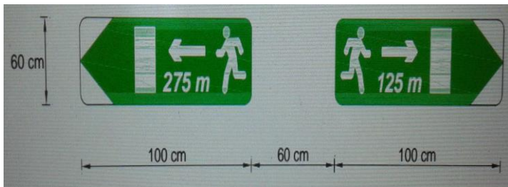
Figura 3.19. Señal de orientación y distancias hasta el refugio salida de emergencia más cercana.
