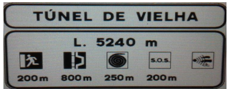
Figura 3.12. Señal para indicar longitud (50m antes de la boca)
