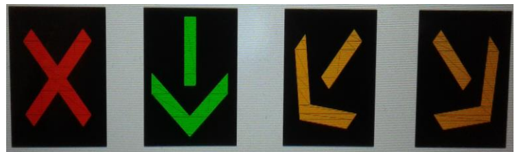
Figura 3.18. Señalización de limitación, apertura o cierre y desvío de carriles.
