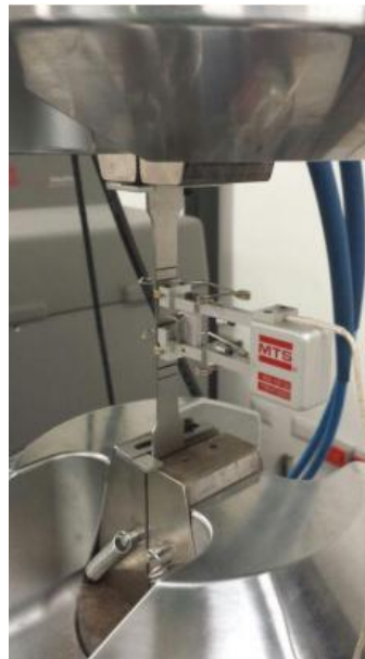
Figura 2.4. Equipo y probetas utilizadas en los ensayos de tracción.
