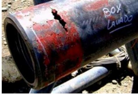
Figura 1.3. Drill collar averiado por vibraciones
