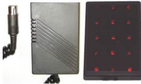
Figura 2.13 Panel frontal y trasero de una plantilla de LEDs infrarrojos.
