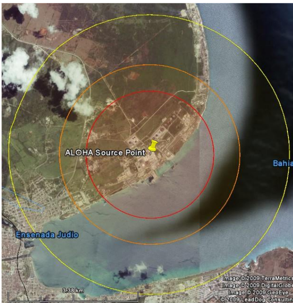
Figura 3.3a: Alcance de las radiaciones de la bola de fuego en el tanque 17
