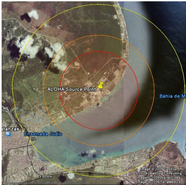
Figura a: Alcance de las radiaciones de la bola de fuego en el tanque 1
