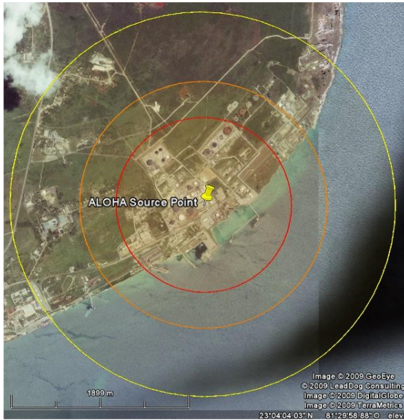
Figura a: Alcance de las radiaciones de la bola de fuego en el tanque 19
