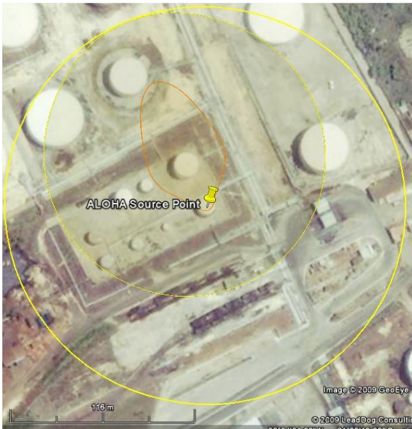
Figura a: Alcance del escenario explosión de una nube de vapor en el tanque 19
