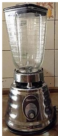
Figura B.9 Licuadora para homogeneizar componentes y muestra
