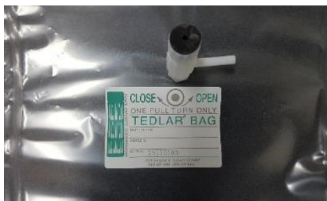
Figura B.18 Bolsa Tedlar para almacenar biogás
