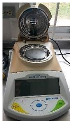
Figura B.10 Balanza para medir humedad
