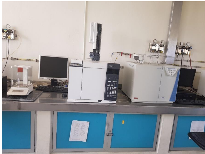
Figura B.27 Equipos de medición elemental y cromatográfico
