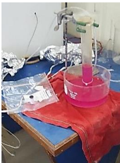
a) Instalación para absorción de CO 2
