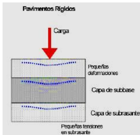
Figura 1.2 Tensiones producidas en pavimentos rígidos
