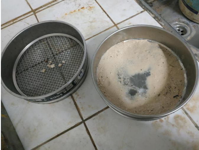
Ilustración 1.9 Empleo de tamices para el lavado de muestras para la determinación de material más fino que el tamiz No. 200. Fuente: Elaboración propia.
