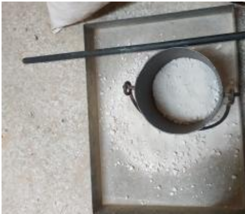
Ilustración 1.11 Recipiente y varilla de compactación empleados en los ensayos de determinación de peso volumétrico. Fuente: Elaboración propia.
