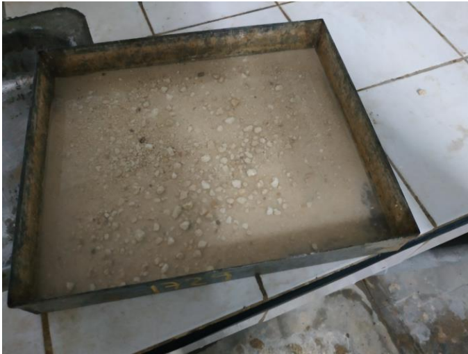
Ilustración 1.8 Lavado de muestras para la separación de material más fino que el tamiz No. 200. Fuente: Elaboración propia.
