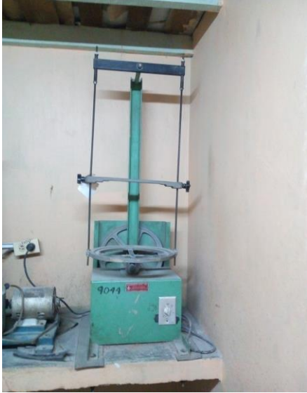
Ilustración 1.7 Tamizadora mecánica. Fuente: Elaboración propia.
