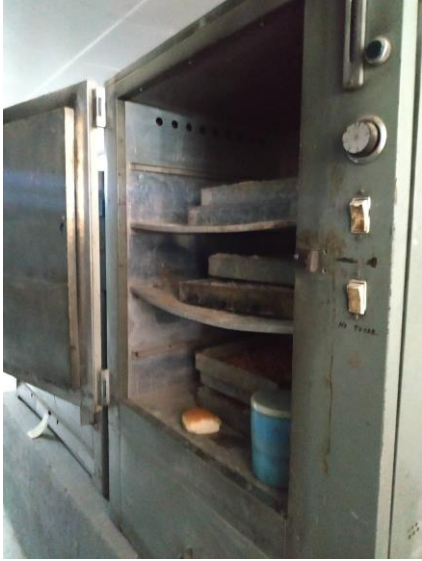
Ilustración 1.5 Horno empleado para el secado de muestras. Fuente: Elaboración propia.
