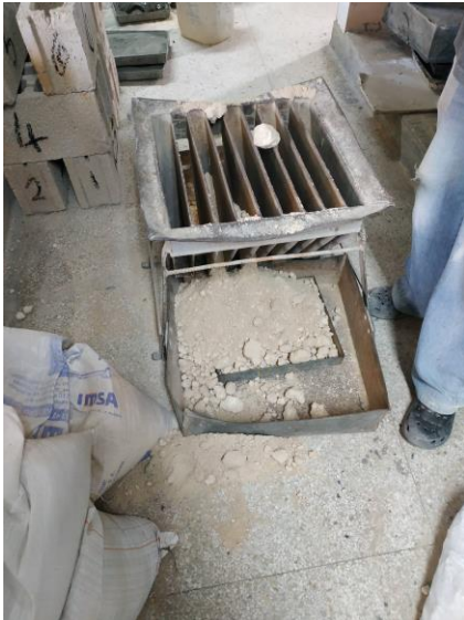
Ilustración 1.4 Uso de cuarteadora mecánica para cuarteado de la muestra. Fuente: Elaboración propia.
