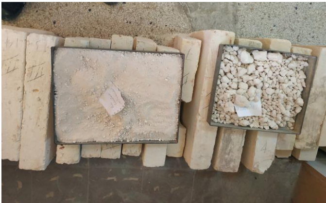
Ilustración 1.6 Fracciones gruesa y fina del árido. Fuente: Elaboración propia.
