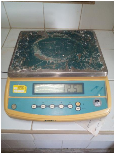
Ilustración 1.10 Pesa empleada para las mediciones en los ensayos de material más fino que el tamiz No. 200 y de granulometría. Fuente: Elaboración propia.
