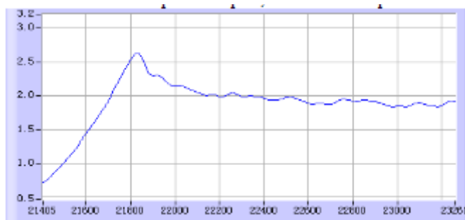
Fig 2. Gráfica obtenida en el software del experimento para la interpretación de la relación que existe entre la fuerza de fricción estática máxima y la fuerza de fricción dinámica.
