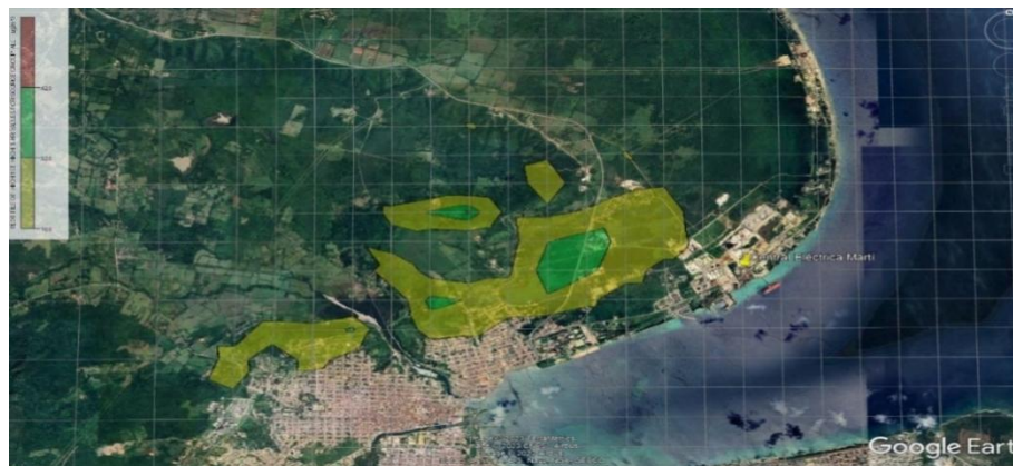
Figura 15 Isolíneas de concentración de NO x , 1 hora. Área donde se superan los valores normados. Elaboración: CUBAENERGÍA.
