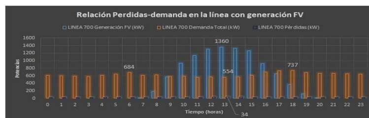
Figura 3.14 Comportamiento horario de las pérdidas de potencia y demanda neta en la línea MU700 para el escenario normal (2.2 MW)
