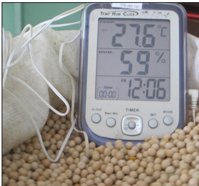
Figura 4. Monitoreo de la temperatura y humedad relativa del almacén mediante termohigrómetro digital.
