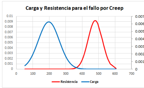
Figura 3.15 Curvas de distribución de probabilidades de la carga y la resistencia al fallo por Creep. (Elaboración propia)
