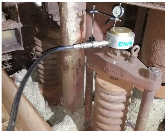
7.3.6 Accionar la bomba manual para incrementar lentamente la presión en el pistón hasta alcanzar la condición de inicio de la apertura de la válvula.
