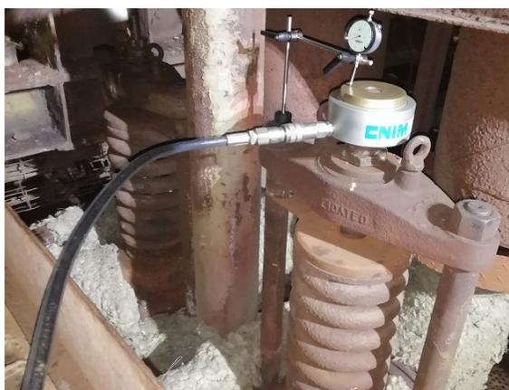
7.3.7 En la condición de apertura de la válvula anote la presión que indica el manómetro del dispositivo de calibración (PH) y la presión en el circuito donde está instalada la válvula de seguridad (PC)
