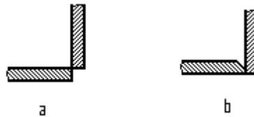
fig. 7.6.Unión en Angulo. a) Sin preparación de bordes, b) Con preparación de bordes
