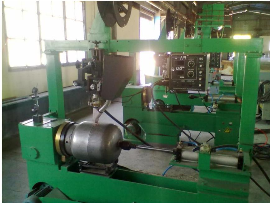
*Figura 5. Posicionador de Soldadura.*
