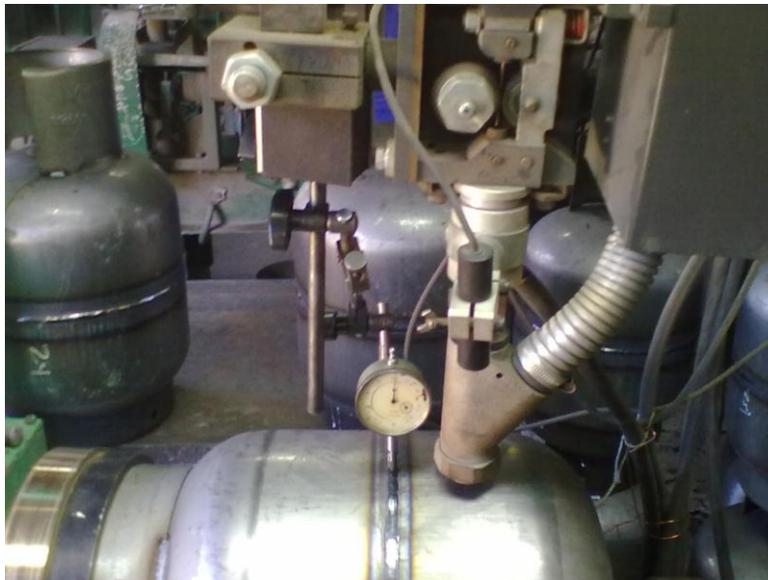
*Figura 10: Medición de la altura de refuerzo.*
