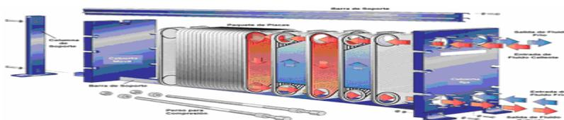
**Figura 1.5 Intercambiador de calor de placas.**
