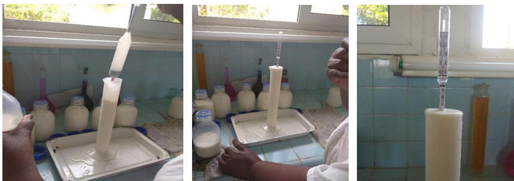
Figura 1. Determinación de la densidad de la leche.
