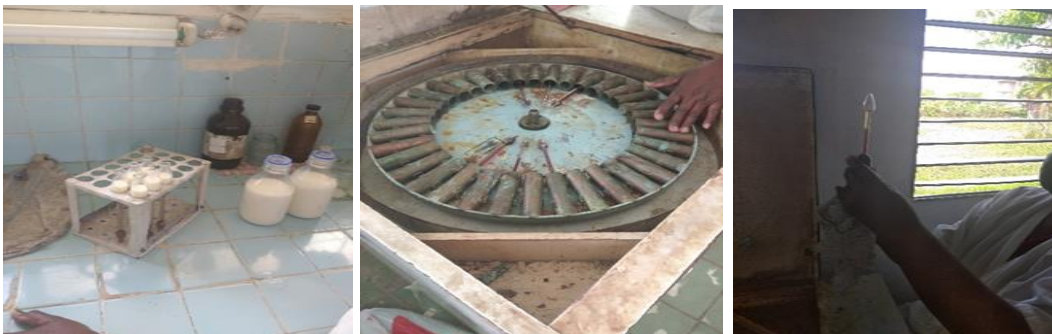
Figura 2. Equipos del laboratorio utilizados para determinar la grasa de leche. Butirómetro y centrifugadora
