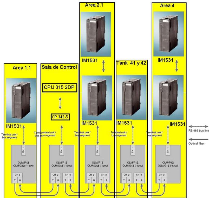
**Figura 3.7.** Red mixta (óptica eléctrica) de la BCS.
