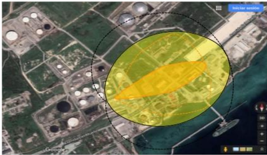
Figura 3.5: Comportamiento de la explosión de una nube de vapor en zonas exteriores para la gasolina de aviación.
