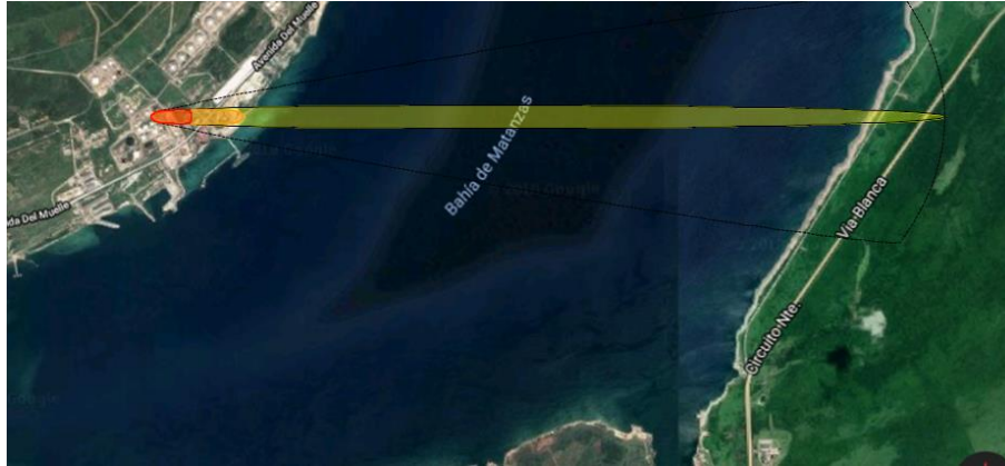
Figura 3.2: Comportamiento de la dispersión de una nube tóxica para el diésel en el mes de julio en la dirección del viento W.
