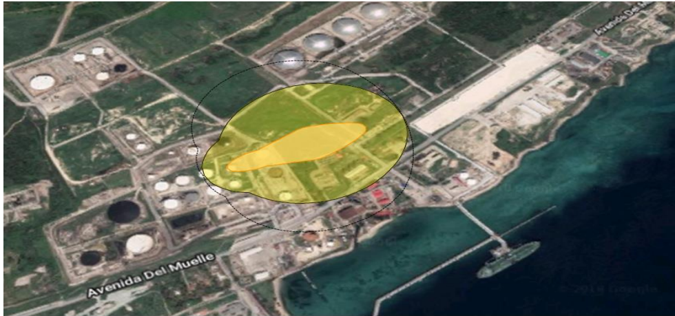
Figura 3.8: Comportamiento de la explosión de una nube de vapor para la nafta en el mes de julio.
