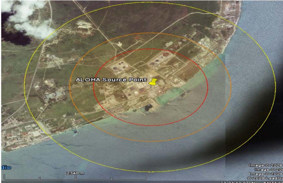
**Figura 3.9:** Alcance de las radiaciones de las bolas de fuego en el tanque 19.
