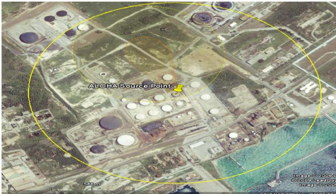
**Figura 3.5:** Alcance del escenario nube de vapor explosiva en el tanque 17.
