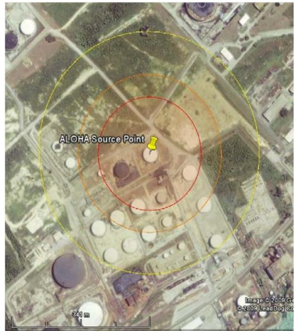
**Figura 3.3b:** Alcance de las radiaciones por un charco de fuego en el tanque 30
