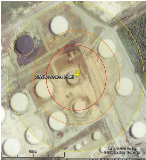
**Figura 3.3a:** Alcance de las radiaciones por un charco de fuego en el tanque 17
