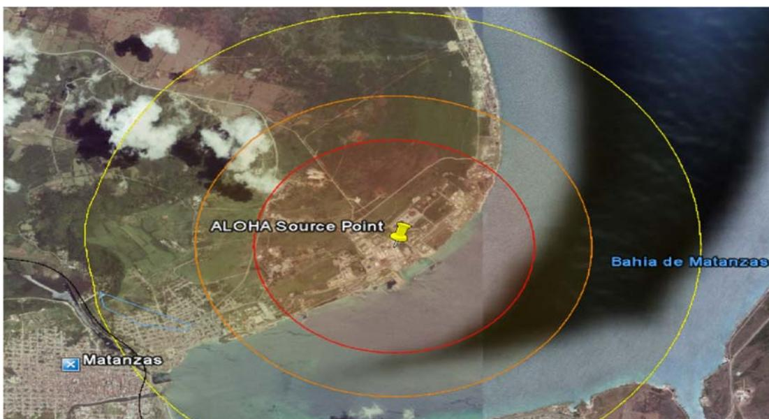
**Figura 3.7:** Alcance de las radiaciones de las bolas de fuego en el tanque 1.
