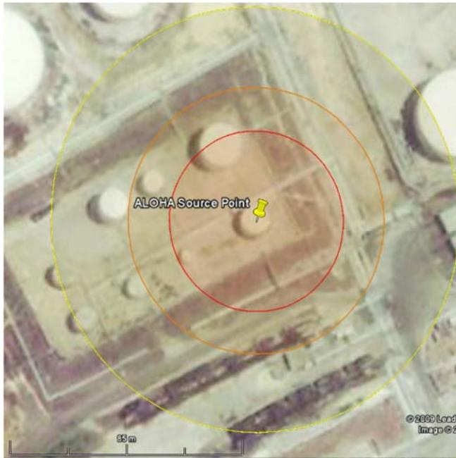
**Figura 3.4a:** Alcance de las radiaciones por un charco de fuego en el tanque 19
