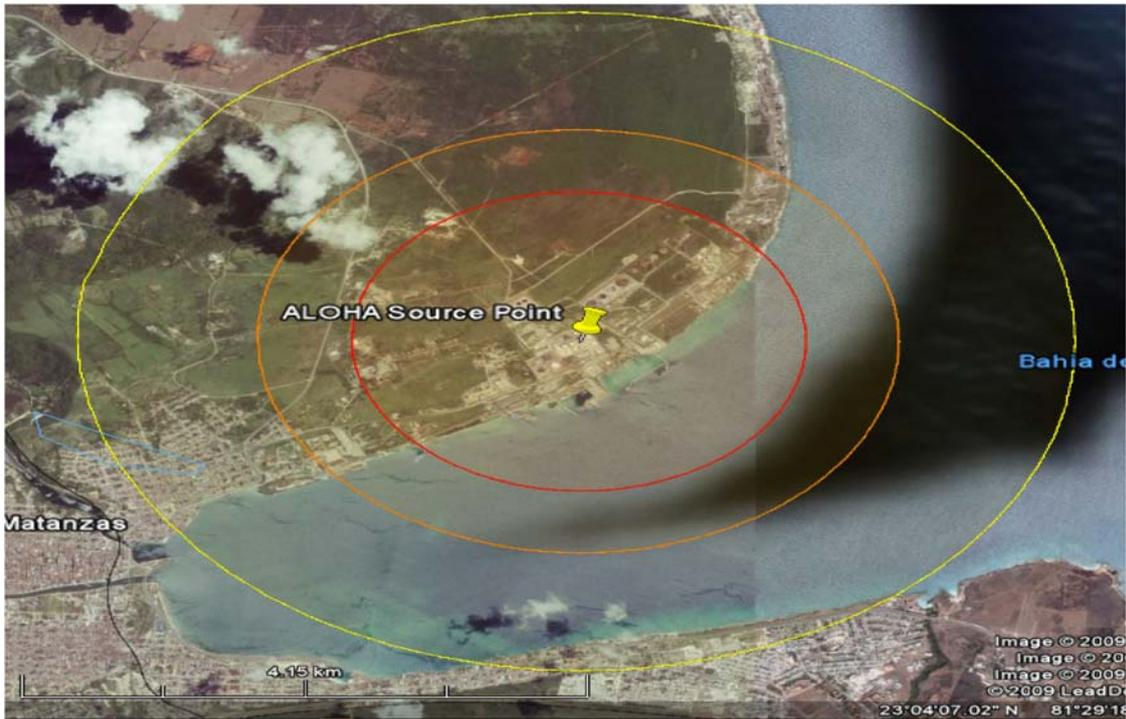
**Figura 3.8:** Alcance de las radiaciones de las bolas de fuego en el tanque 17.
