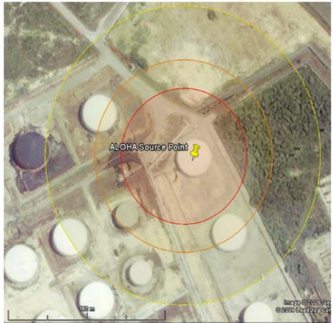
**Figura 3.4b:** Alcance de las radiaciones por un charco de fuego en el tanque 1
