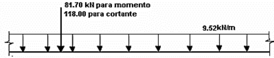
Figura 1.4 Esquema de las cargas distribuidas y concentradas para el vehículo normativo MS-32. (Normalización, 2009)
