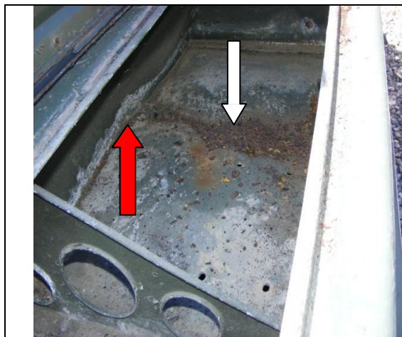
Fig.1. Imperfecciones en la superficie de la soldadura (rojo), resquicio (blanco), zona de acumulación y depósito (amarillo), componente hueco (azul). Corrosión electroquímica atmosférica húmeda localizada e intersticial.
