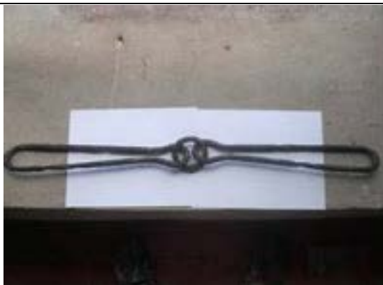
Fig. 22. Grillete. Presenta corrosión electroquímica atmosférica generalizada.
