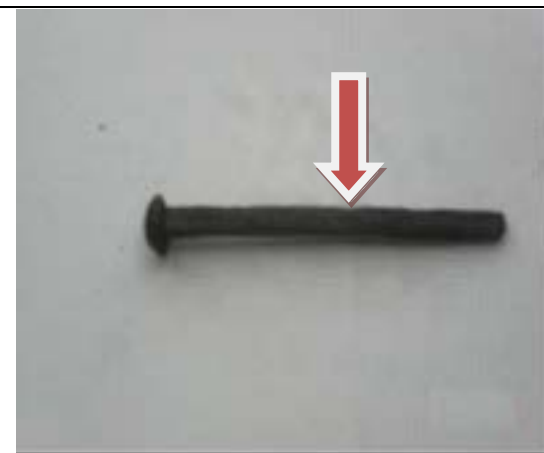
Fig. 15. Clavo. Presenta problemas con los bordes. Corrosión electroquímica atmosférica generalizada.
