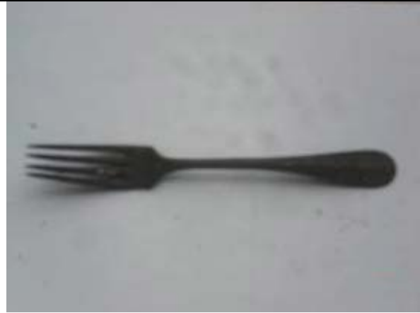
Fig. 28. Tenedor de Alpaca Cafetal La Dionisia, Canímar, Matanzas (siglo XIX). Presenta Corrosión electroquímica atmosférica generalizada.
