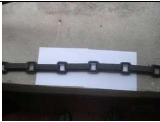
Fig. 23. Grillete. Presenta corrosión electroquímica atmosférica generalizada.
