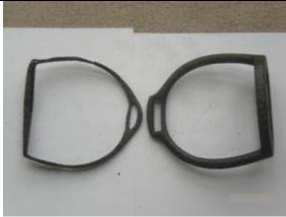
Fig. 27. Estribos de montar caballo Cafetal La Dionisia, Cañamar, Matanzas (siglo XIX).Acero al carbono. Presenta Corrosión electroquímica atmosférica generalizada.
