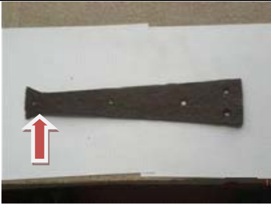
Fig. 13. Fijador de marco. Presenta problemas con los bordes. Corrosión electroquímica atmosférica generalizada.
