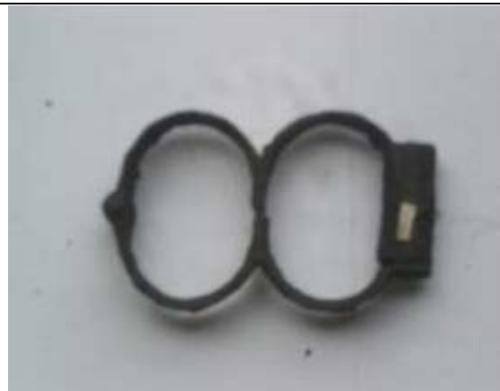
Fig. 26. Grillete. Presenta Corrosión electroquímica atmosférica generalizada.
