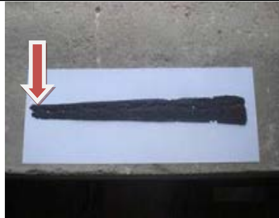
Fig. 7. Machete de Plantación Sierra de Pan de Azúcar Pinar del Río (siglo XIX). Acero al carbono. Presenta problemas de bordes. Corrosión electroquímica atmosférica generalizada
