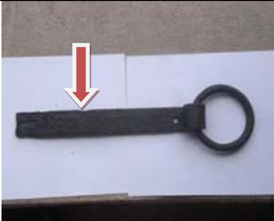
Fig. 20. Planchuela con argolla. Presenta problemas con los bordes de corrosión electroquímica atmosférica generalizada.
