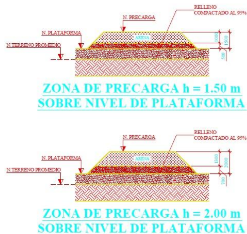
Figura 3.5 Detalle de Precarga. Fuente: Plan General Movimiento de tierras, zonas de Precarga.
