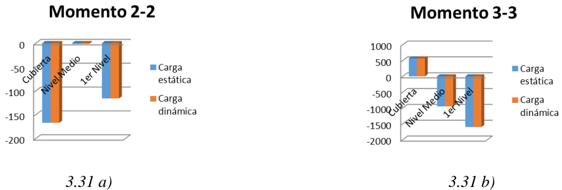
Figura 3.31 Valores de Momento 2-2 a), y Momento 3-3 b) en el pórtico 1
