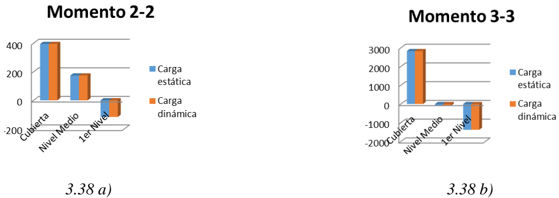
Figura 3.38 Valores de Momento 2-2 a), y Momento 3-3 b) en el pórtico 8
