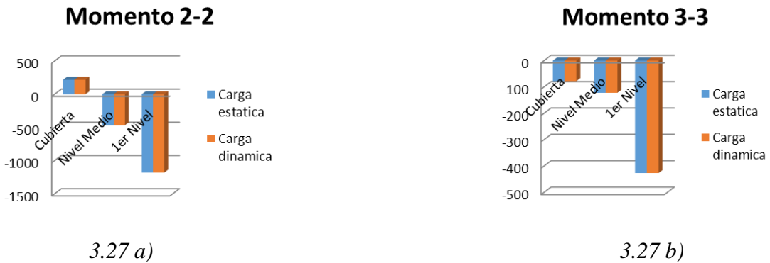
Figura 3.27 Valores de Momento 2-2 a), y Momento 3-3 b) en el pórtico D
