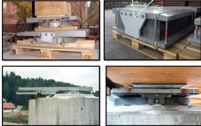
Figura 2.11: Sistema de Apoyo. Variante para la etapa deslizable y final Fuente: ( Ideas Conceptuales del Puente en el Abra del Yumurí, 2013 ).
