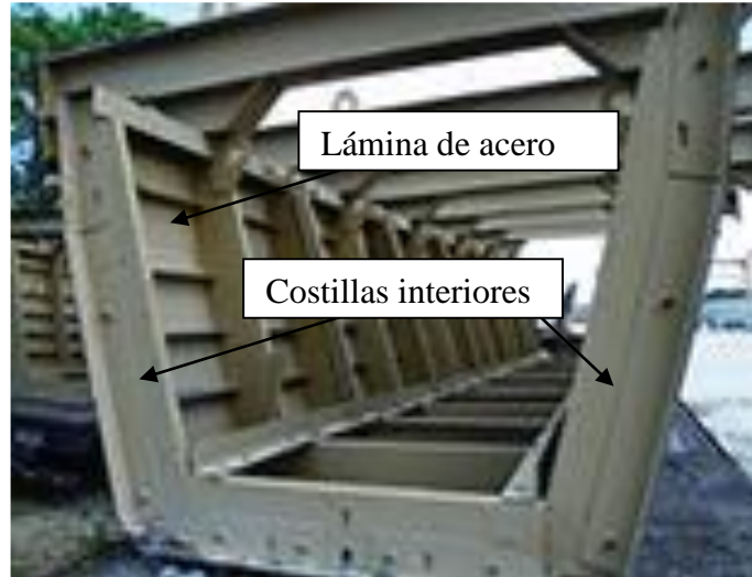
Figura 1.8 Molde de viga. Cama superior. Fuente (Nickas & Dick, 2015).
