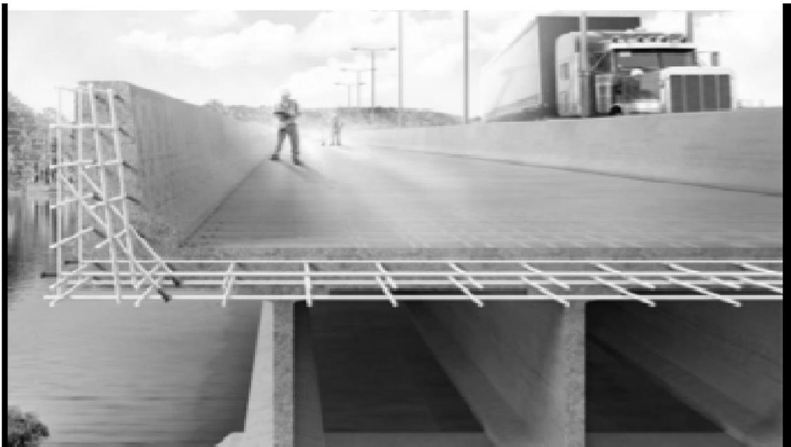
*Figura 1.2 Tablero de puente reforzado con PRFV. (ARMOTEX, 2015f)*
