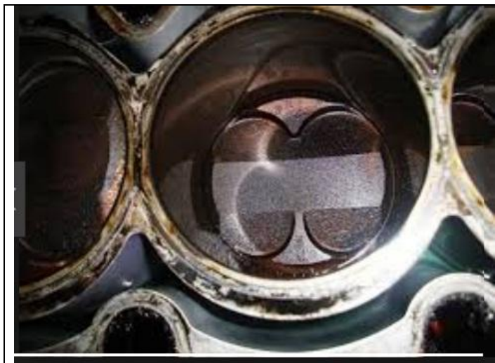
Figura 3.5 Examen endoscópico antes de la conservación.
