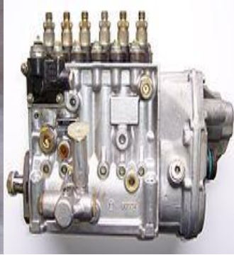
Bomba de inyección
