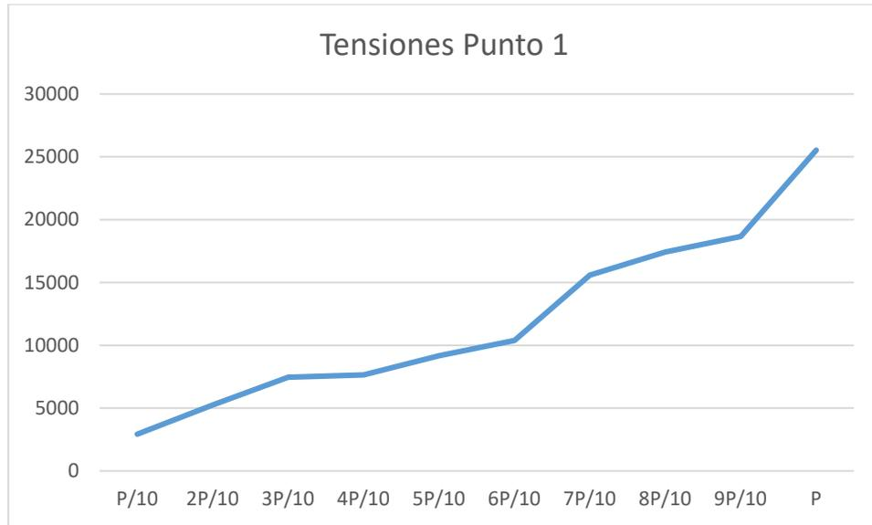
Figura 3.12: Prueba de tensiones cercanas al gancho de izaje.(Elaborada por la autora)
