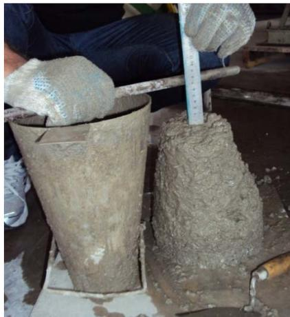
*Figura 2.3. Experimento del cono de Abram.*
