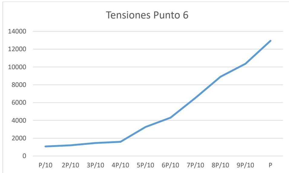
Figura 3.17: Prueba de tensiones cercanas al gancho de izaje.(Elaborada por la autora)
