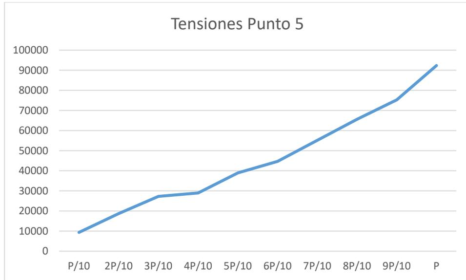
Figura 3.16: Prueba de tensiones cercanas al gancho de izaje.(Elaborada por la autora)
