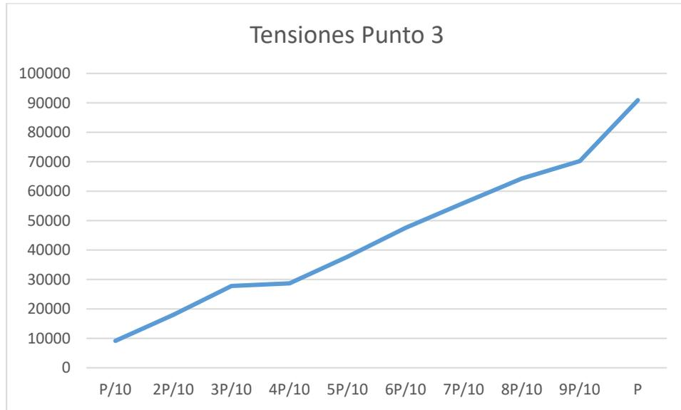
Figura 3.14: Prueba de tensiones cercanas al gancho de izaje.(Elaborada por la autora)
