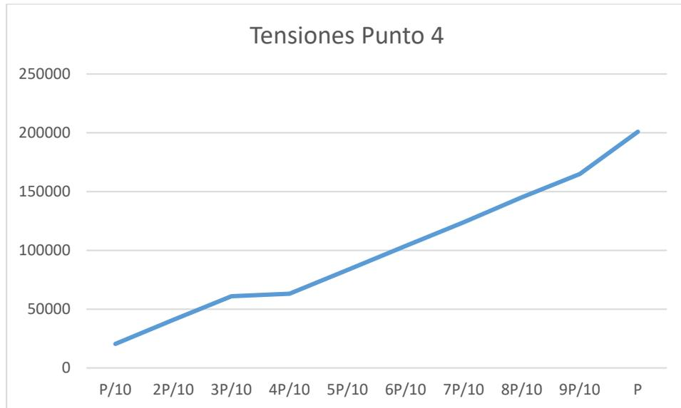
Figura 3.15: Prueba de tensiones cercanas al gancho de izaje.(Elaborada por la autora)
