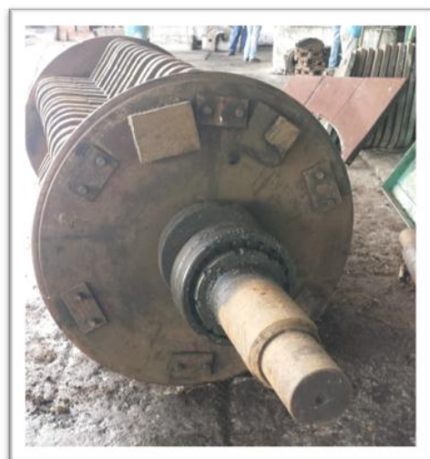
Anexo 2 Conjunto del eje de la cuchilla picadora de caña sin los machetes.
