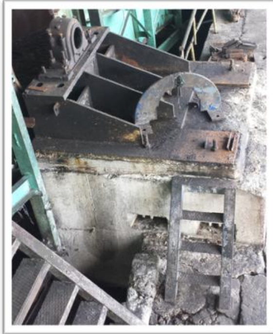
Anexo 2 Conjunto del eje de la cuchilla picadora de caña sin los machetes.
