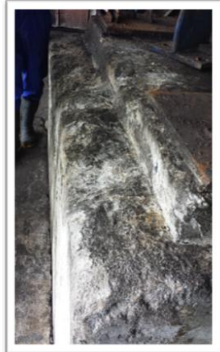
Anexo 2 Conjunto del eje de la cuchilla picadora de caña sin los machetes.
