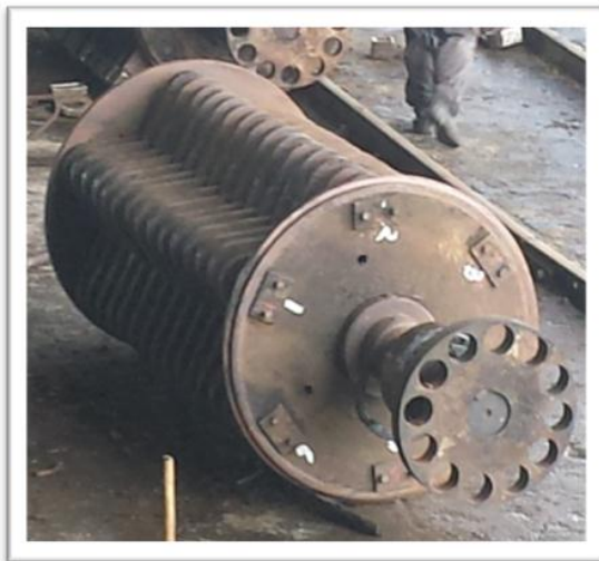
Anexo 2 Conjunto del eje de la cuchilla picadora de caña sin los machetes.
