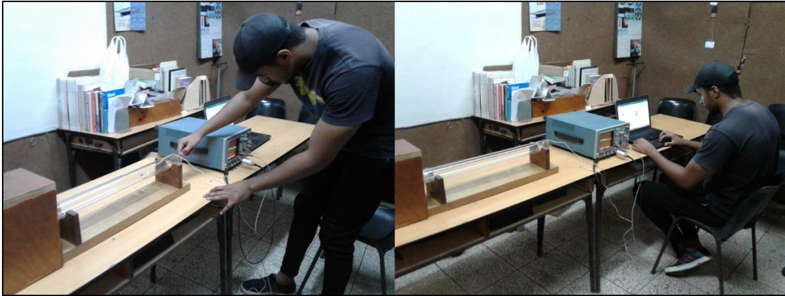
Figura 3.6: Proceso de medición de los máximos y mínimos de presión.
