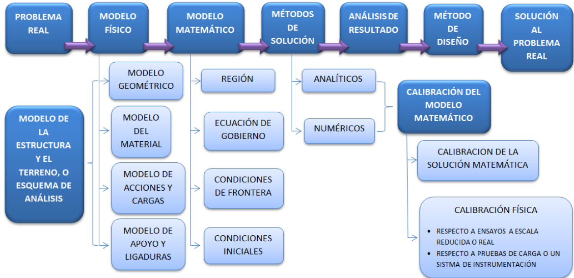
Figura 1.4 Etapas de la modelación estructural(García, 2015)
