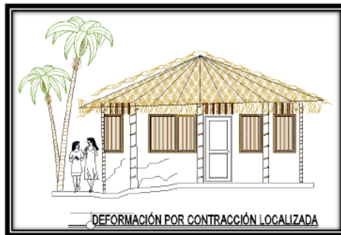
Figura 1.5 Deformación por contracción localizada (Mijangos, 2006)
