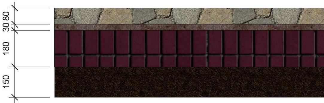
**Figura 3.3: Estructura del pavimento de adoquines**
