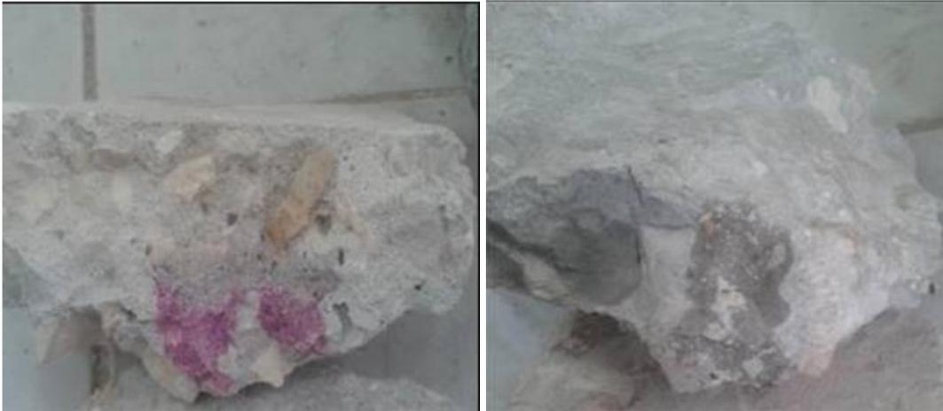
*Figura 1. Muestras carbonatadas parcial y totalmente respectivamente.*
