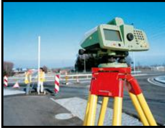
Figura 2.1: Niveles digitales Leica DNA
