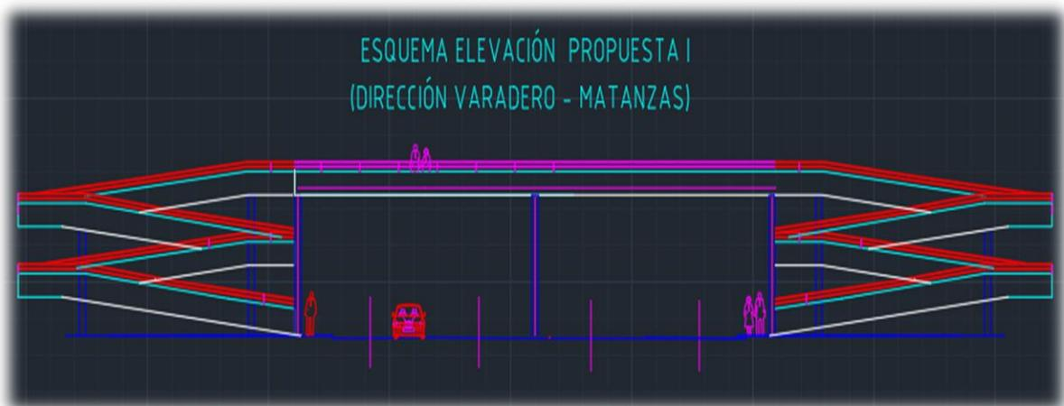
**Figura 3.9** Elevación de la Propuesta I de la Pasarela Peatonal. (Accesos perpendiculares al eje de la vía.)
