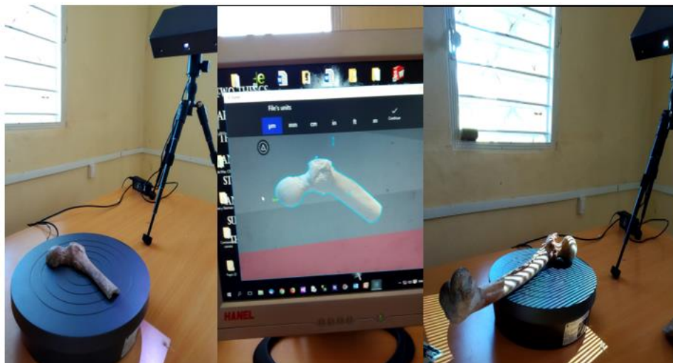
Figura 1.32: Escáner Think3D del CEFAS escaneando un fémur humano.
