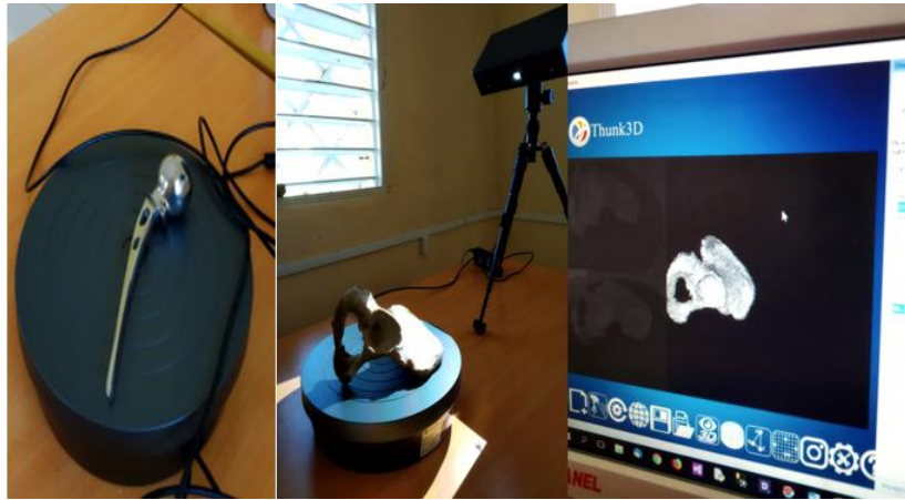
Figura 1.33: Escáner Thunk3D del CEFAS escaneando una cadera humana y una prótesis de cadera parcial.
