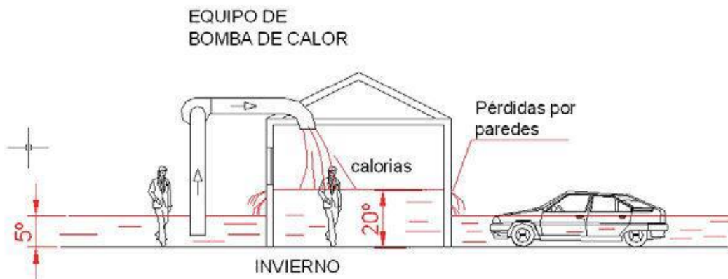
Figura 1.4 Bomba de Calor en Invierno
