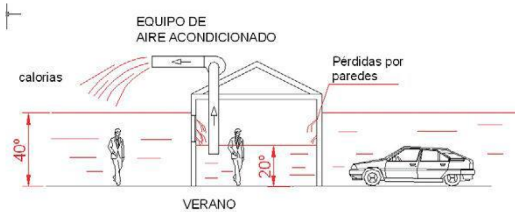
Figura 1.3 Equipo de Aire Acondicionado en Verano
