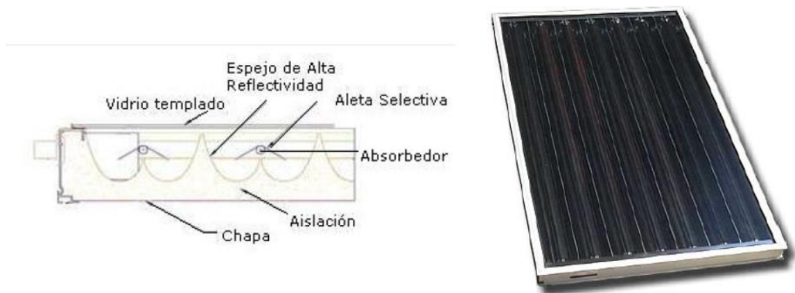
Figura 1.3a) Esquema de Colector CPC Estacionario y b) Foto de CPC Estacionario
