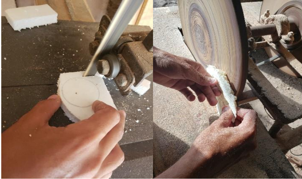
Figura 3.5: Operaciones en la elaboración y conformación de las probetas
