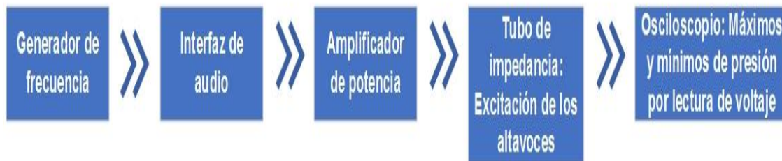
Figura 2.4: Diagrama de flujo- Medición del coeficiente de absorción a incidencia normal.
