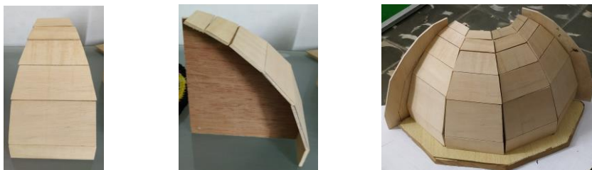
Figura 3.1. Encofrado de la concha acústica a escala 2:100. Fuente: elaboración propia.
