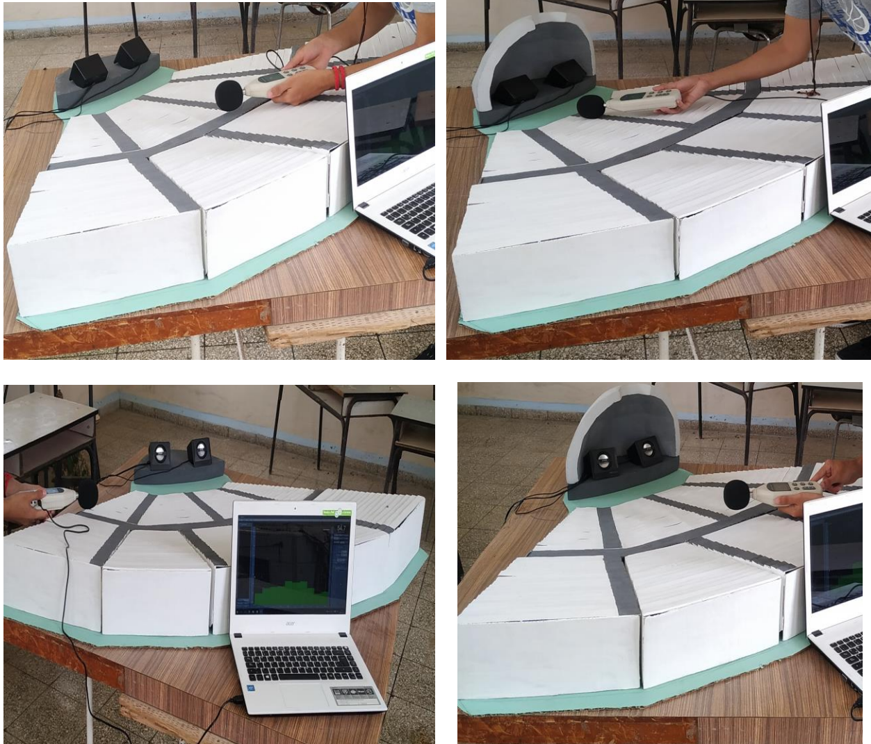
Figura 3.6. Montaje experimental para el análisis de la variable presencia-ausencia de la concha con la generación de tonos puros en determinadas frecuencias.
