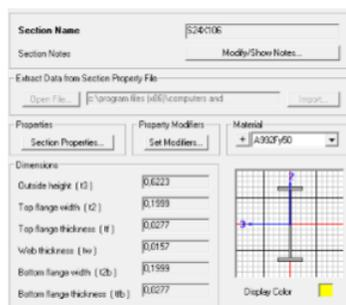
*Figura 3.21 Sección S24x106. Fuente: Software SAP2000*
