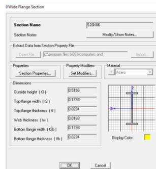
Figura 3.8 Sección S20x86. Fuente: Software SAP2000.
