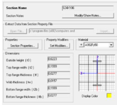
Figura 3.13 Sección S24x106. Fuente: Software SAP2000
