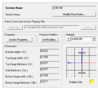
Figura 3.13 Sección S24x106. Fuente: Software SAP2000
