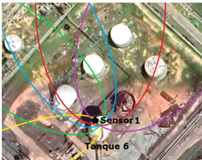
Figura 3.8 Ubicación del sensor de H 2 S en el área de confluencia de las cinco nubes tóxicas provenientes de tanque 6
