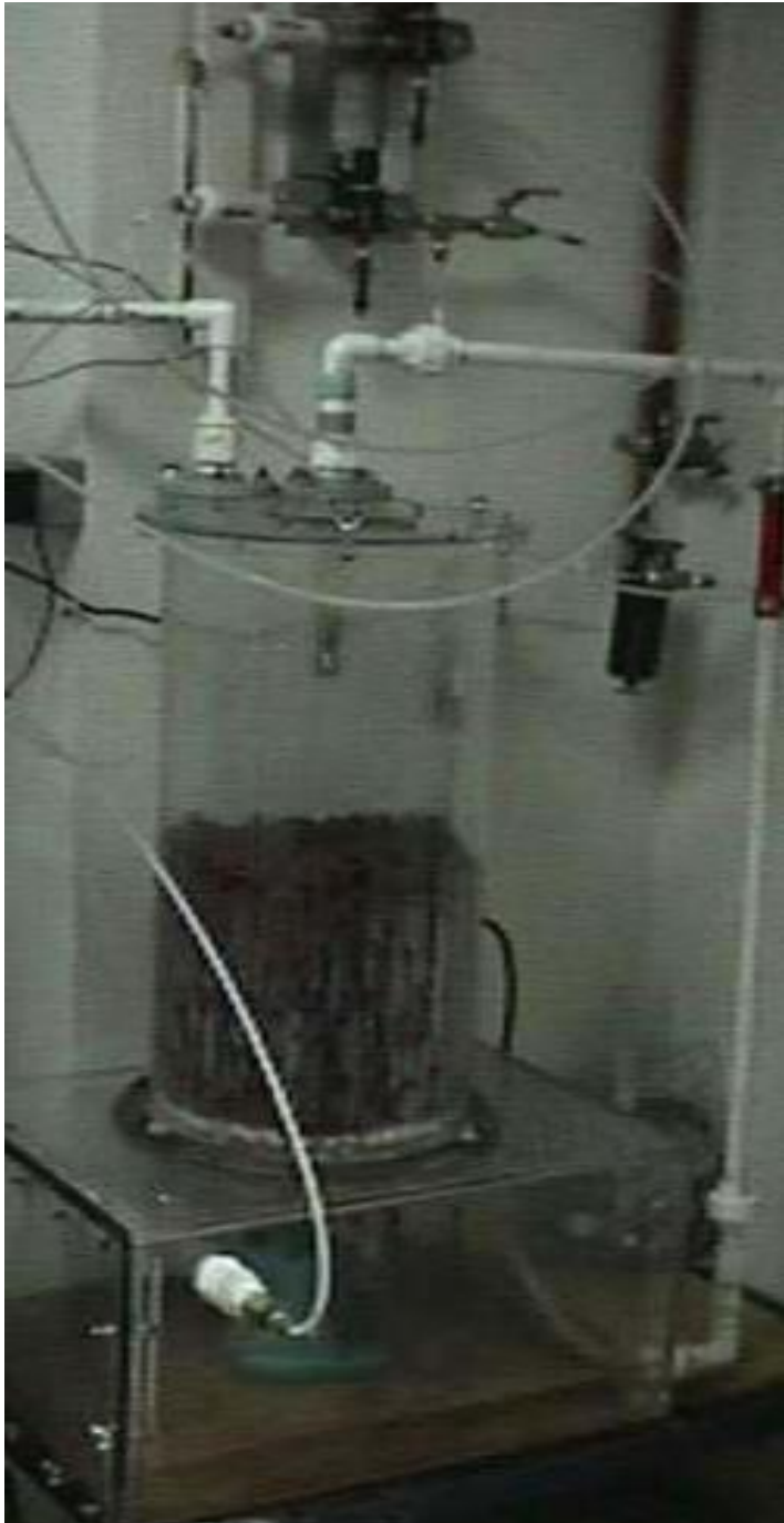
Figura A.1 Equipo para la Biofiltración (columna empacada) Fuente: Díaz, (2019)
