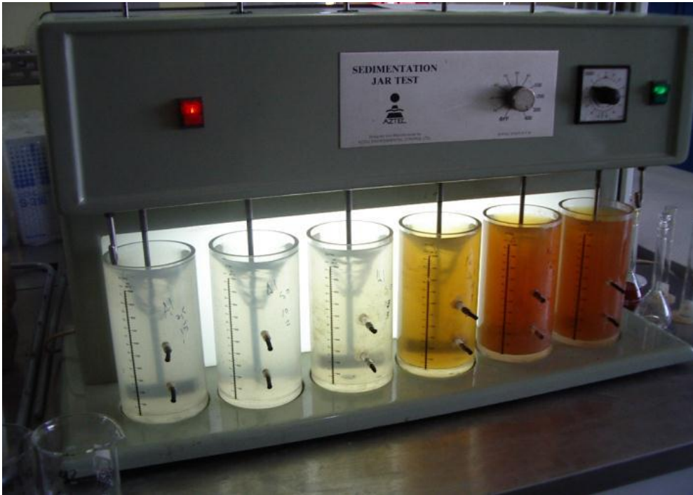
Figura A.2 Equipo Jar Test Fuente: Díaz, (2019)
