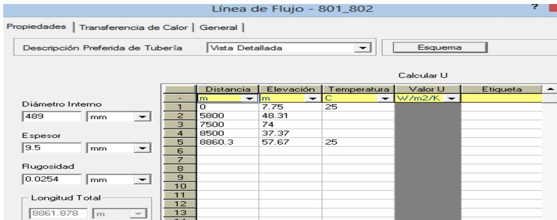
**Figura 2.3 Datos geométricos correspondientes al tramo del oleoducto (ECO a VC-802)**
