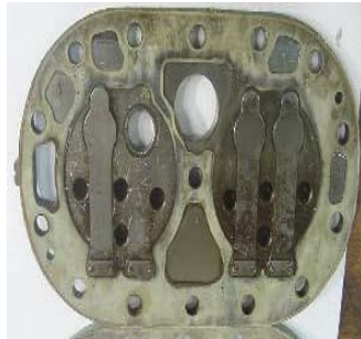
Figura 1.9 Avería de la válvula de succión del conjunto plato de válvulas causada por la tentativa de comprimir refrigerante líquido o aceite o ambos
