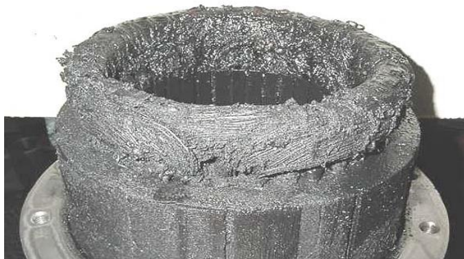
Figura 1.14 Quemado completo de los bobinamientos.
