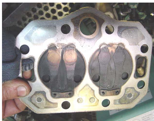
Figura 1.11 Un plato de válvulas bastante dañado por la alta temperatura de descarga.
