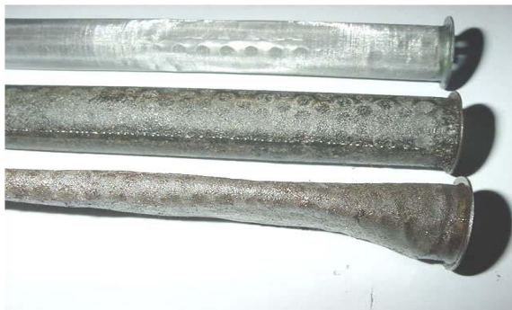
Figura 1.13 Aquí se encuentra tres filtros de aceite. El de arriba está limpio mientras que el del medio y el último está contaminado.
