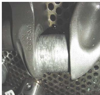
Figura 1.10 Se observa la forma por el cual el metal de las bielas de aluminio está esparcido en la superficie del cigüeñal esto ocurre porque hubo una dilución del aceite.
