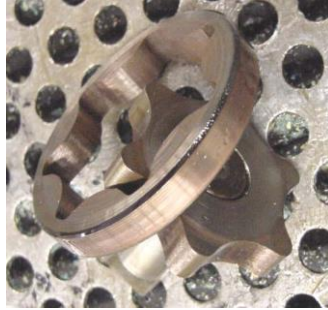
Figura 1.12 La bomba de aceite se ve altamente revestida de cobre
